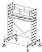
Arbeitshöhe: 4,40 m Gerüsthöhe: 3,40 m Standhöhe: 2,40 m
