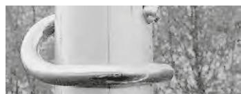
Tous les raccords à emboîtement doivent être sécurisés par des crochets.
