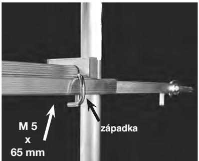
Zavěste stabilizační sadu do šroubů s okem na stěně. Stabilizační sadu namontujte na příčel pod nejvyšší plošinou.
