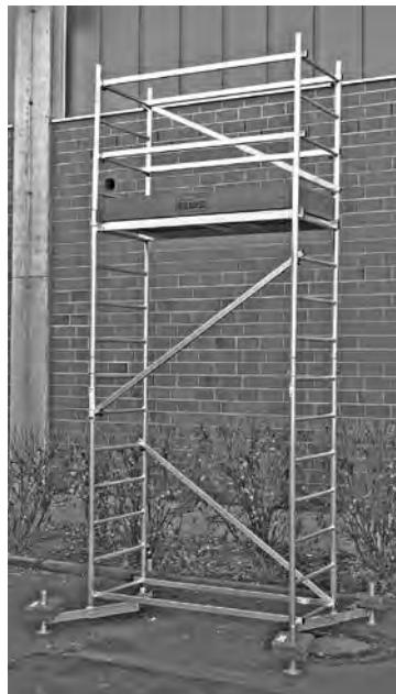
La ilustración muestra el andamio completamente terminado con el primer piso y 8 pesos de lastre.
