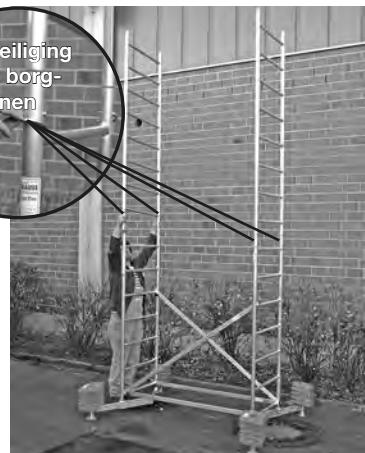
Basisplatform met eerste en tweede slag
