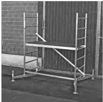
Şekilde montajı tamamlanmış alt iskele görülmektedir.
