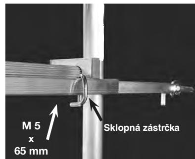
Zaveste stabilizačnú súpravu do skrutky s okom na stene. Namontujte stabilizačnú súpravu na priečke pod najvrchnejšou podlahou plošiny.
