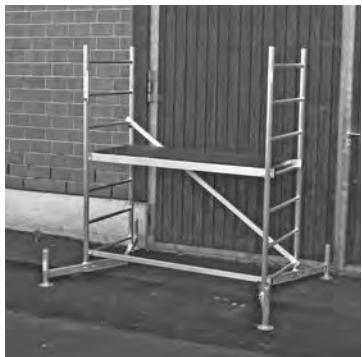
Na zdjęciu gotowa, zmontowana podstawa rusztowania.
