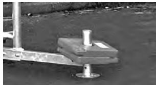
Na zdjęciu balastowanie stabilizatora.
