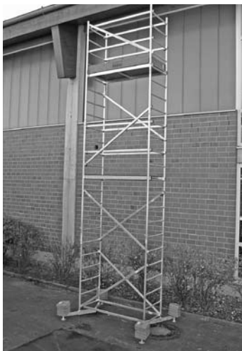
Grundgerüst mit erster und zweiter Aufstockung
